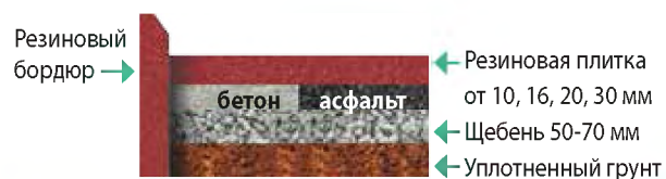
Схема 2: Вариант укладки на твердое основание
